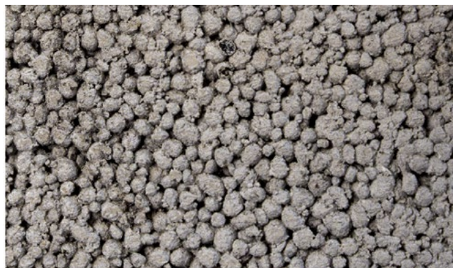
Figur 3.6 Porøsitet i Leca lettklinkerbetong
